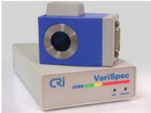
Slika 23: Nastavljivi tekočerkristalni filter (modra škatlica) s kontrolno enoto in primer grafov prepustnosti za model s širino spektralnih pasov 20 nm. [36]
