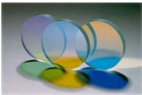
Slika 16: Posnetek nazorno prikazuje lastnosti dvobarvnih zrcal, ki jih vidimo delno v odbiti, delno pa v prepuščeni svetlobi. [28]
