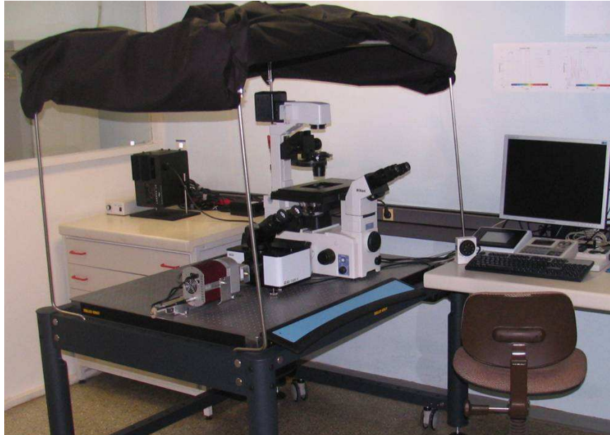
Slika 20: Postavitev sistema v laboratoriju: na optični mizi v sredini slike so od desne proti levi vidni mikroskop, konfokalna komponenta ter kamera, med katerima je nameščen še tekočekristalni filter, levo v ozadju je prostostoječa svetilka, na desni mizi pa kontrolne enote.
