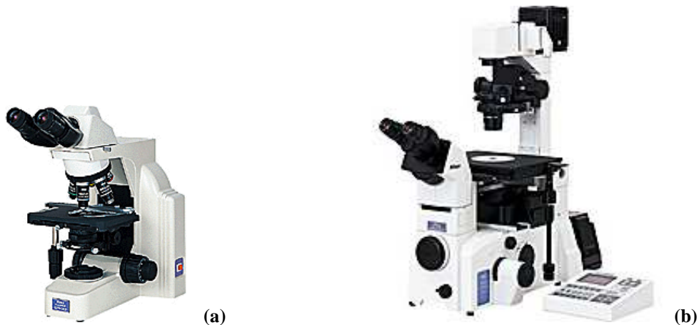
Slika 6: Primerjava pokončnega (a) in obrnjenega mikroskopa (b). [17],[18]
